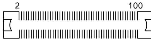
Mini PCI Socket pin orientation
